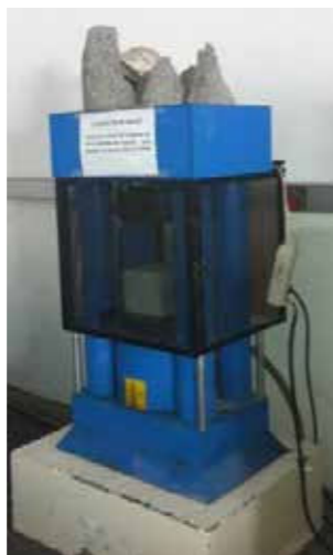
Figure 28- Presse à béton : éprouvettes cylindriques et cubiques
