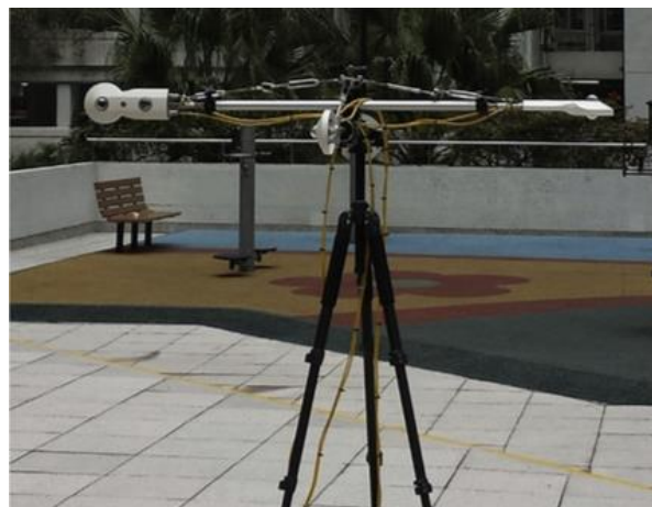
Figure 3.2 : Mesure intégrale des flux radiatifs avec radiomètres (Lai et al., 2017). L'environnement est séparé en directions perpendiculaires afin de représenter le champ radiatif en trois dimensions.
