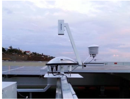
Figure 3.12: Imageur Sky InSight™ utilisé dans le cadre de l'expérimentation. (Crédit photo : Réuniwatt)
