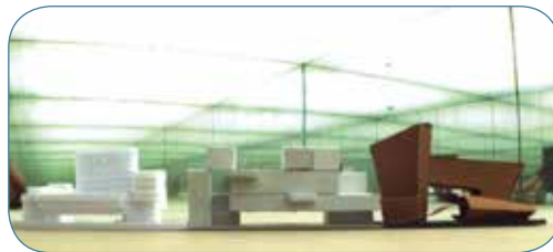
Exemple de ciel artificiel à parois miroir © Ljubica Mudri
