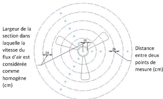
On calcule le débit d'air dans chaque section, en multipliant la vitesse d'air moyenne calculée sur les trois directions par la section. Il suffit ensuite de sommer les débits de section pour obtenir le débit total.
