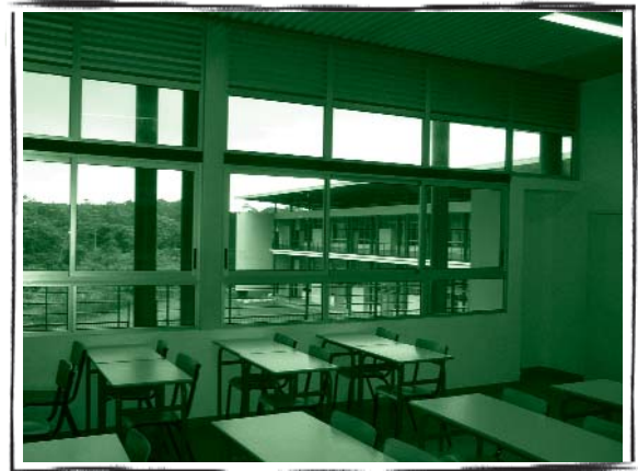
Grande baies vitrées permettant un très bon éclairage naturel. A contrario, si elles ne sont pas bien protégées à l'est ou à l'ouest, cela peut être préjudiciable pour les apports de chaleur. (Matoury 3 - architecte : C.Jensen)
