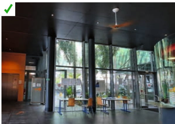
Un large patio apporte une lumière naturelle indirecte dans le hall d'accueil rafraîchi par la ventilation naturelle, des ventelles et des brasseurs d'air. Une ouverture partielle du patio sur le parvis crée aussi un espace tampon entre le tumulte de la ville et l'intérieur de l'édifice. ©AQC
