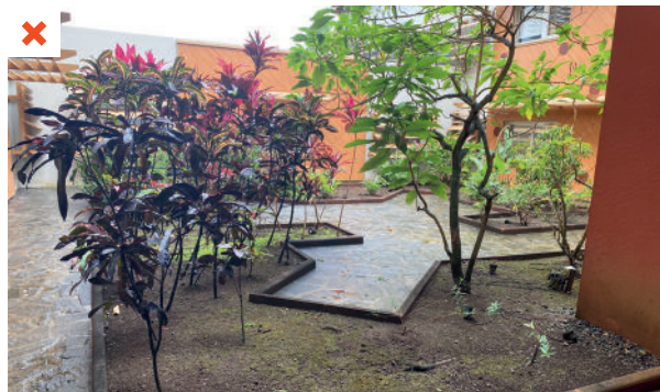
Patio sans strate basse. La faible densité de la végétation ne permet pas d'obtenir l'effet d'îlot de fraîcheur recherché. ©AQC
