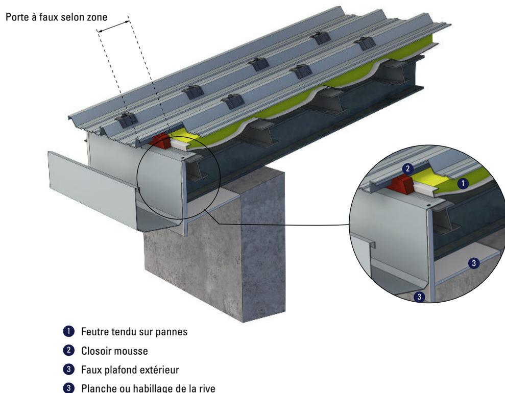
**Figure 53 – Isolation sur pannes – Exemple de réalisation en faîtage**
