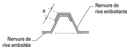
La largeur minimale de la nervure mâle doit permettre une solidarisation correcte des plaques nervurées à leur emboîtement longitudinal au moment de la pose.
