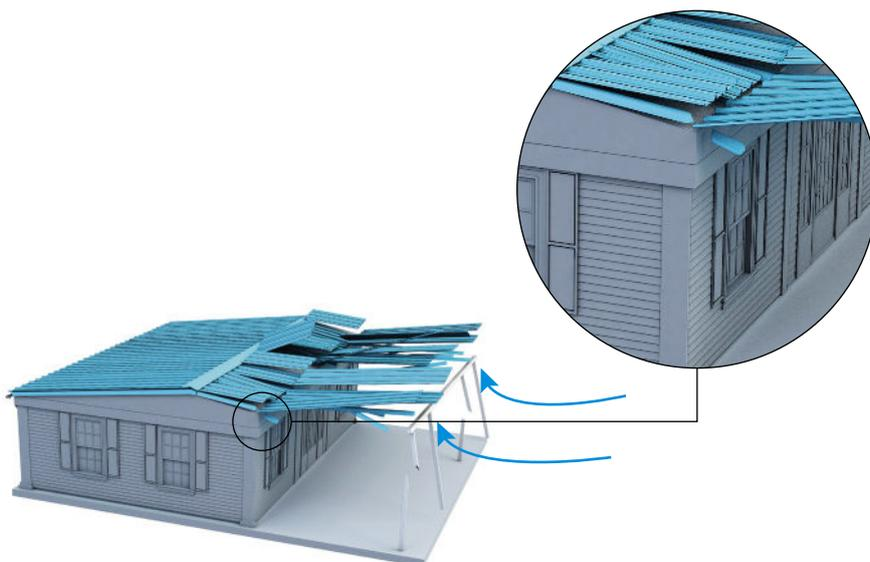
Figure 26 – Effet du vent sur la couverture dans le cas d'un ouvrage annexe désolidarisé
