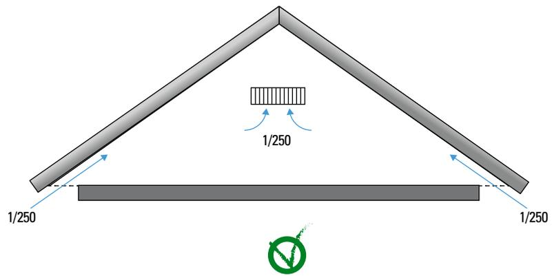
**Figure 31 – Sections de ventilation des couvertures froides ventilées des couvertures isolées**
