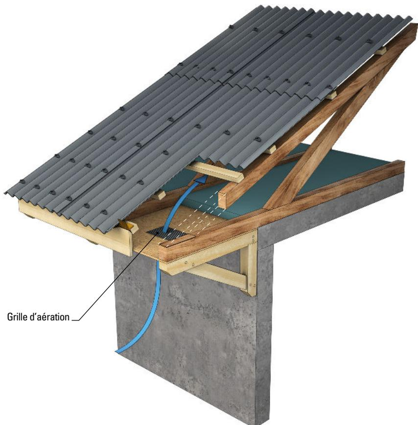
En pignon, la ventilation est obtenue par l'implantation dans les façades de dispositifs types grilles, jalousies ou ventelles (cf. figure 34), nécessitant une implantation en haut de pignon, protégées par des avancées de toitures suffisantes pour se prémunir des risques de pénétration d'eau.
