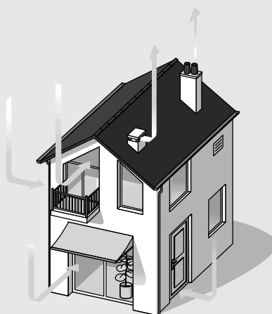
Figure 2.2 : pour protéger le bâti, apporter l'oxygène nécessaire à notre santé, et pour évacuer les polluants, il faut veiller à renouveler l'air à l'intérieur de nos locaux par l'installation d'un système de ventilation.
