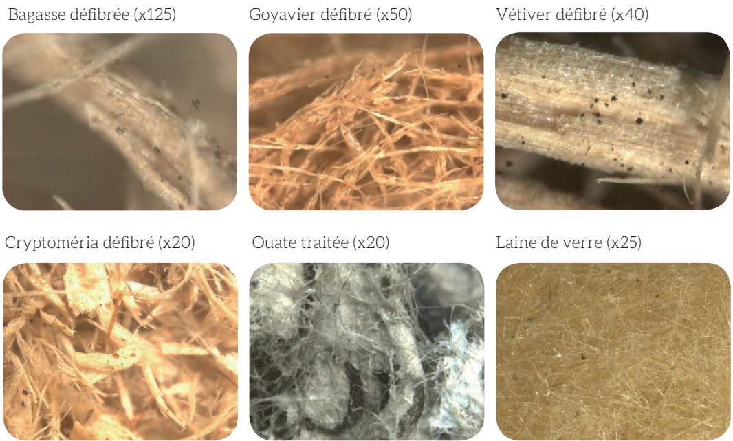
Figure 16 : Photographies en fin d'essai sur les matériaux testés, à la loupe binoculaire – Test à 28°C et 85 % d'humidité relative après exposition aux moisissures pendant 4 semaines.
