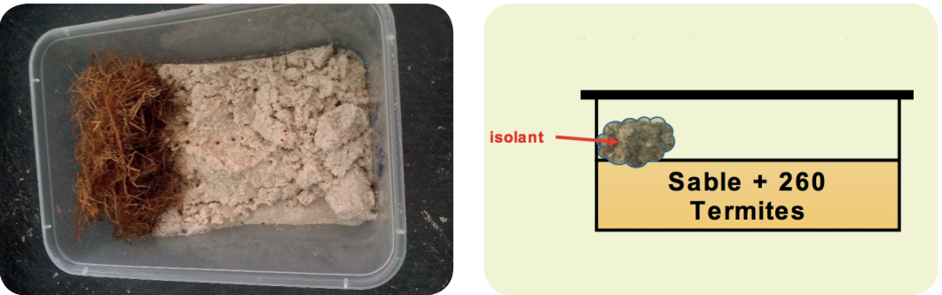
Figure 20. Dispositifs d'essais réalisés selon la norme EN 117 adaptée
