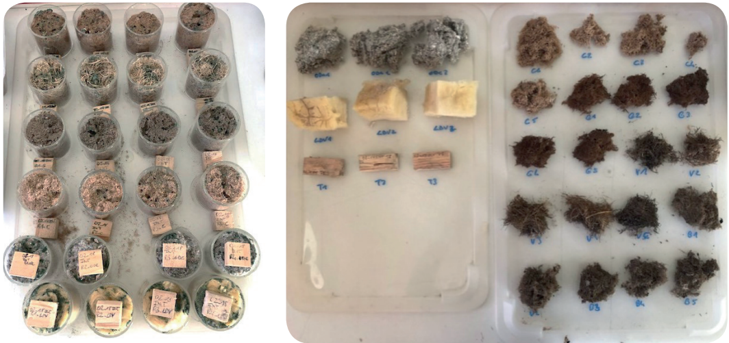
Figure 21. Illustration des matériaux testés face aux termites après mise en présence (à gauche : selon XP X 41550 – à droite : selon EN 117)
