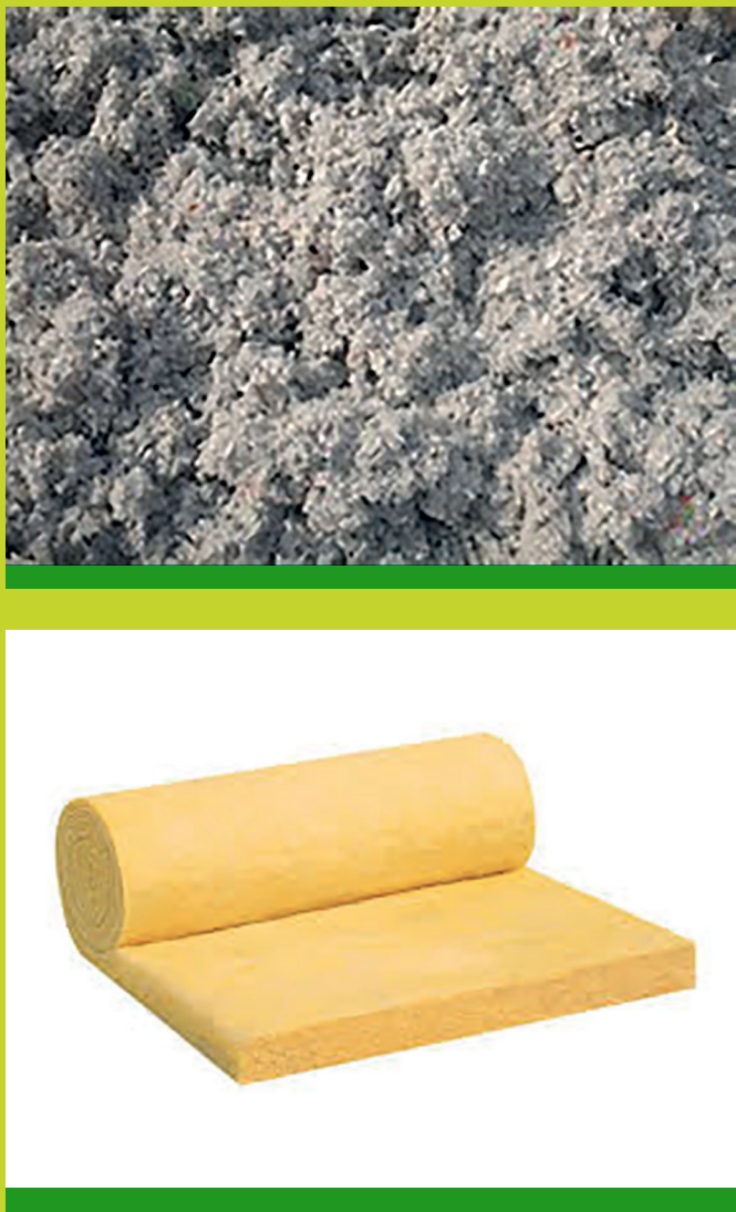
Figure 5. Matériaux témoins : Dessus : Ouate de cellulose traitée - Dessous : Laine de verre
