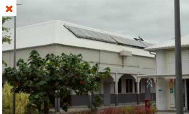
Aucune vanne d'équilibrage n'a été mise en œuvre sur la production solaire assurée par différentes nappes de capteurs. ©AQC
