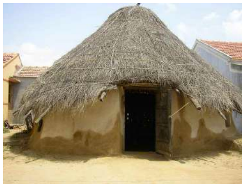
Figure 6 : Bhunga traditionnelle en bauge (Chiodero, 2008, p. 17)
