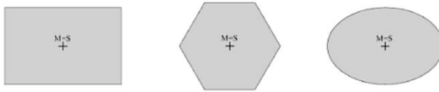
Figure 23 : Exemples de formes favorables. La présence de plusieurs axes de symétrie assure la régularité et la compacité
