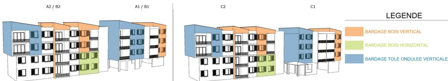
Figure 9 : Les Mahots, repérage volumétrique des bardages bois et tôle ondulée, façade ouest
