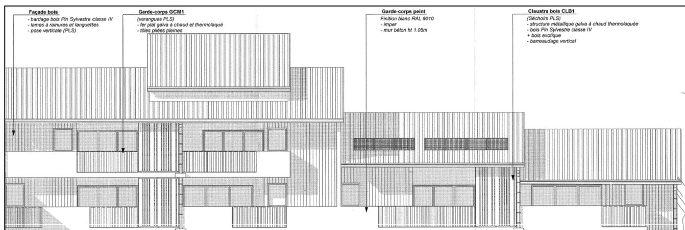
Figure 32 : Plan de façade explicitant la mise en place des bardages, garde-corps ou claustra
