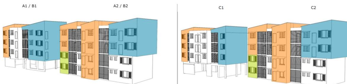
Figure 10 : Les Mahots, repérage volumétrique des bardages bois et tôle ondulée, façade est
