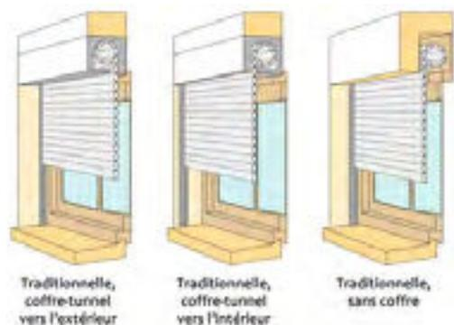
Un point d'attention devra être porté sur l'étanchéité à l'air au niveau des traversées vers l'intérieur (câble ou, plus délicat à traiter, manivelle si volet roulant manuel) ou du coffre en lui-même si posé en tunnel.
