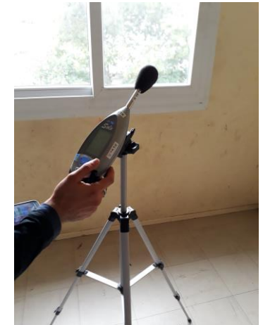
Appareil de mesure et enregistrement placé dans le local récepteur
