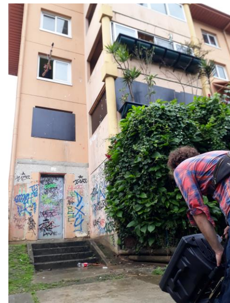
Simulation d'une nuisances sonore type bruit rose à l'aide d'une enceinte auto-amplifiée
