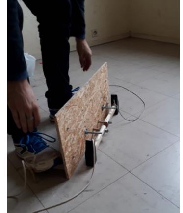
Simulation de bruits de chocs dans le local émetteur
