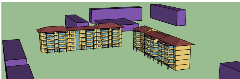
Modèle numérique d'une opération de logement collectif pour simulation STD
