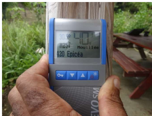
Figure 8 : Mesure d'humidité du bois à l'aide d'un humidimètre capacitif
