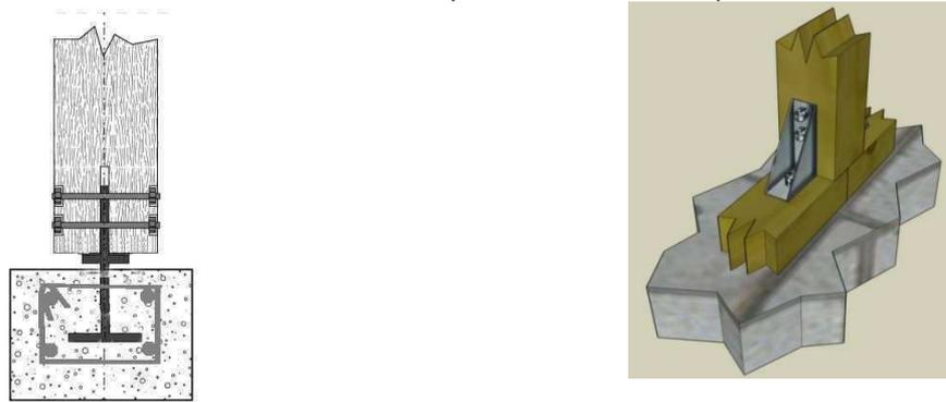
Figure 109- Exemples de schéma d'ancrage de poteau support de ferme sur infrastructure ba
