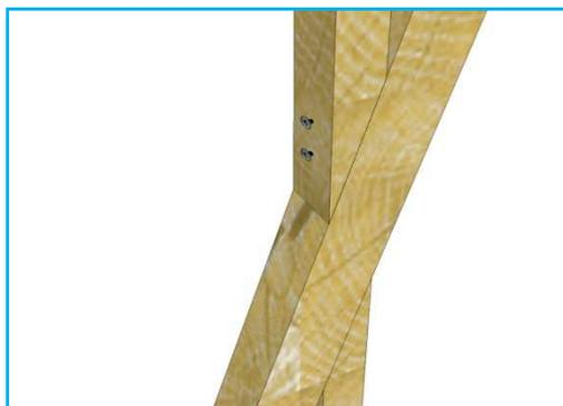
Figure 84-schéma assemblage écharpe/montant intermédiaire palée PST4
