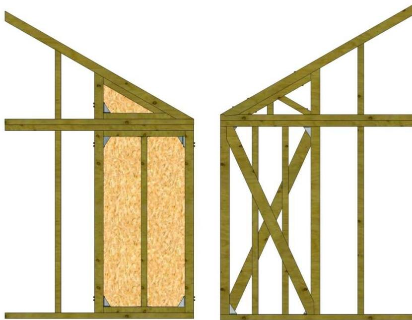
Figure 131- Schémas de principe d'assemblage des panneaux de contreventement sous charpente.
