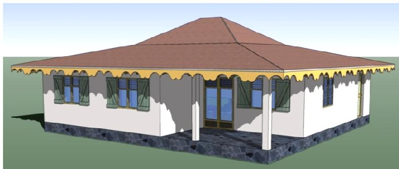
Figure 96- Toiture à 4 versants avec rupture de pente
