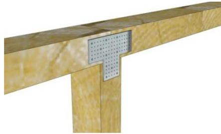
a) assemblage avec plaque métallique
