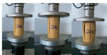
Figure : Évolution de la forme de l'éprouvette à mesure que la contrainte augmente.
