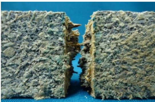
Figure 2: exemple d'expérimentation de béton de fibre de bambou réalisé en laboratoire au Brésil
