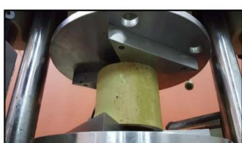
Figure : Évolution de la forme de l'éprouvette à mesure que la contrainte augmente.
