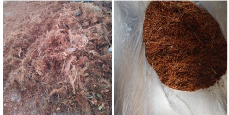
Fibres de coco : extraites (gauche), découpées (droite)
