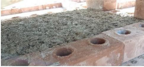
Sur la base de la brique modèle (25x12.5x8 cm<sup>3</sup>) réalisée précédemment, des panneaux moulés, avec de plus grandes dimensions que la brique (50x75x8 cm<sup>3</sup>), ont été expérimentés. Cependant, la technique employée à plus petite échelle ne s'est pas avérée reproductible pour des panneaux
