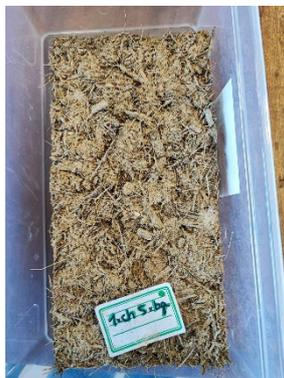
*Brique isolante fibrée (Masse volumique apparente : 0.4 g.cm<sup>-3</sup> ; conductivité thermique : 0.11 W.m/k)*
