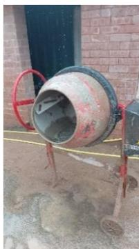
**Figure 13 : bétonnière de 120L pour la réalisation des mélanges**
