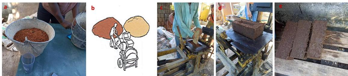
**Figure 8 : 4 étapes de production des BTCF : Pesage des matières premières (a), Malaxage des MP terre et fibres/feuilles (b), Remplissage du moule de la presse et éjection du bloc (c, d), Stockage sur palette et séchage à l'abri des blocs (e)**
