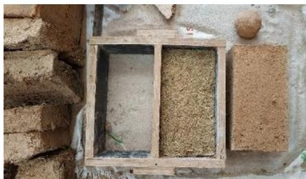
**Figure 16 : Démoulage et séchage d'une brique d'adobe terre-fibres**
