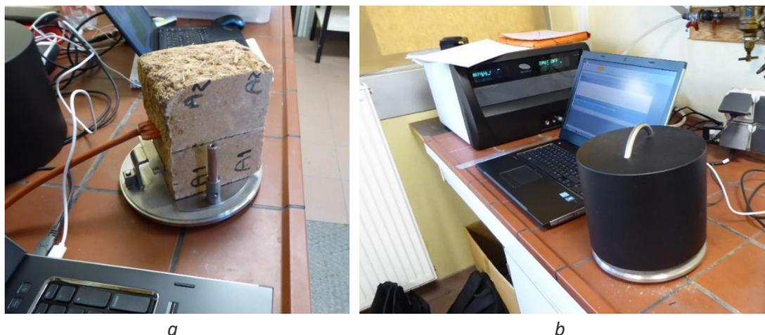
Figure 26 : Caractérisation de la formulation A avant (a) et après (b) la pose du capot de protection permettant de s'affranchir des flux convectifs au sein du laboratoire
