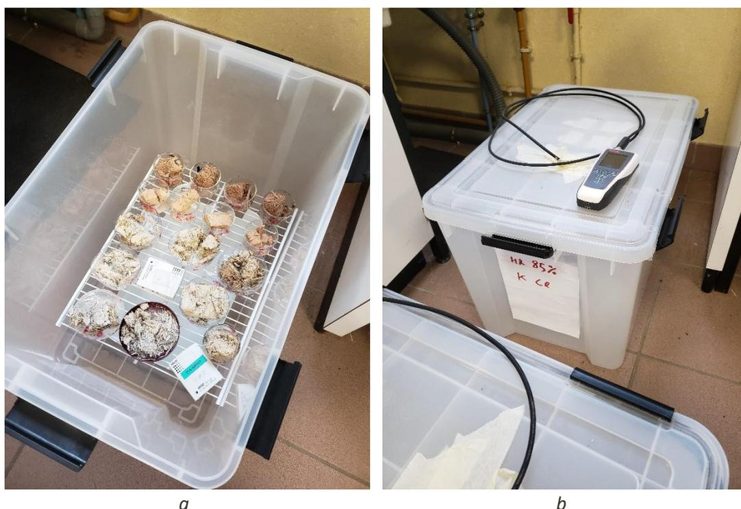
**Figure 29 : Exemple de la boîte contenant une solution saline saturée de KCl (régulation de l'humidité à 85%)**
