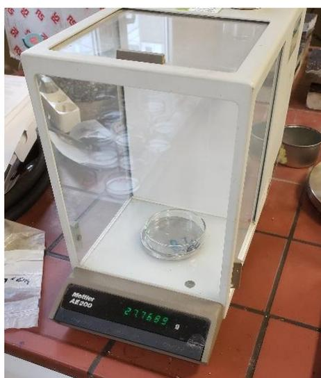
**Figure 28 : Photographie de la balance AE200 utilisée pour la pesée des échantillons**
