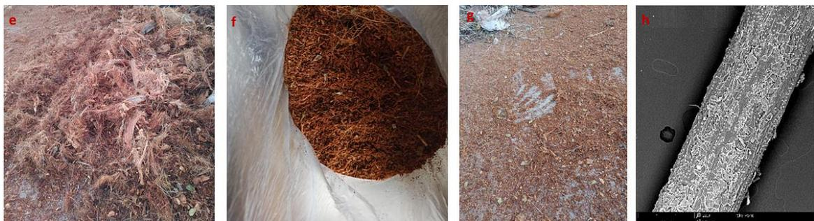
Figure 6 : Fibres de coco : extraites (e), pilées (f), résidus séparation fibres/coques (g), rugosité de surface d'une fibre de coco observée au Microscope Electronique à Balayage (échelle 300µm) (h)
