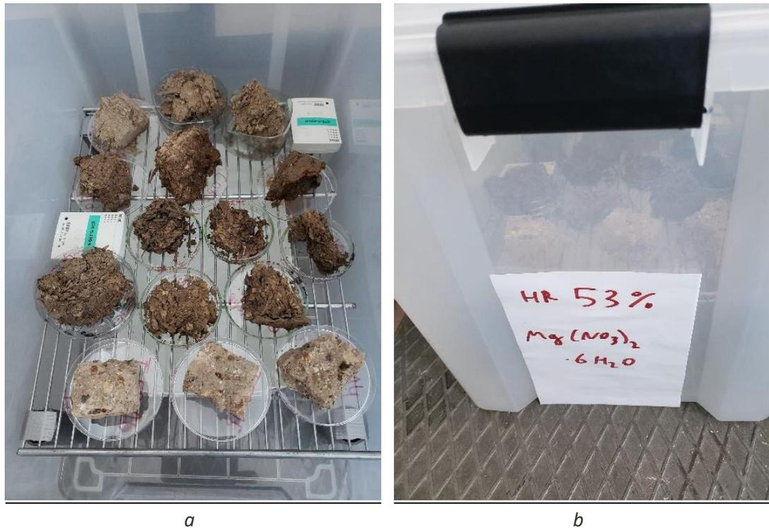
**Figure 31 : Exemple de la boîte contenant une solution saline saturée de  $Mg(NO_3)_2 \cdot 6H_2O$  (régulation de l'humidité à 53%)**
