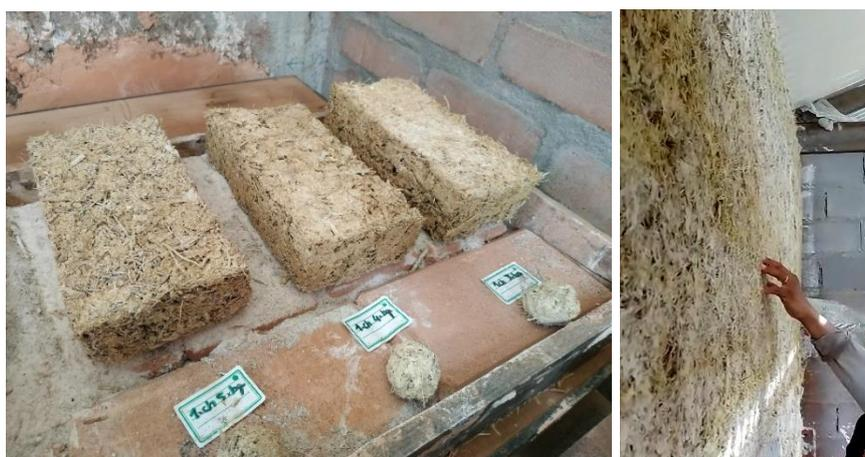
Figures 20 et 21 : Doublage isolant de bagasse stabilisée à la chaux
