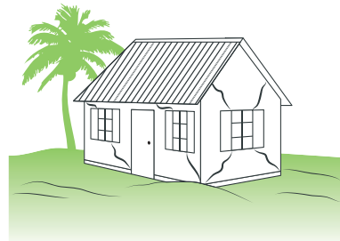
Figure 17 : Rupture des murs résistants (séisme)
