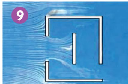
**Fig.10** - Cloisonnement coupant le flux : perturbations. La pièce fermée n'est pas ventilée, l'autre l'est très faiblement.
