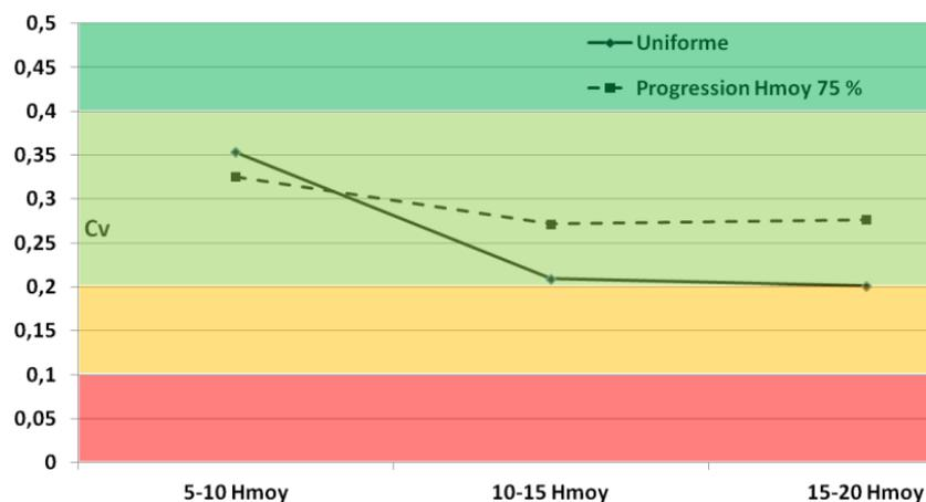
Figure 41: Evolution de  $C_v$  en fonction de la distance à la lisière - Progression  $H_{moy}$  75 %
