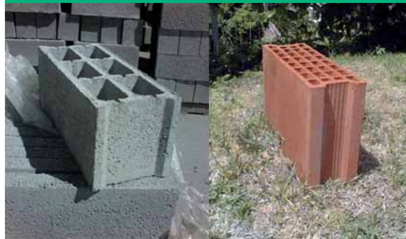
Bloc creux ou parpaing de 20 cm d'épaisseur à 3 parois longitudinales, pouvant être utilisé dans les murs de contreventement.
