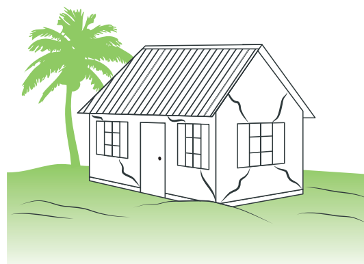
Figure 17 : Rupture des murs résistants (séisme)
