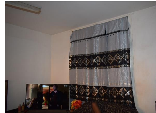
Opération Doujani : rideaux opaques pour se protéger de l'ensoleillement et des vis-à-vis mais bloquant la ventilation naturelle
