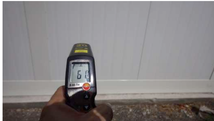
Température radiante d'une façade exposée d'un modulaire
