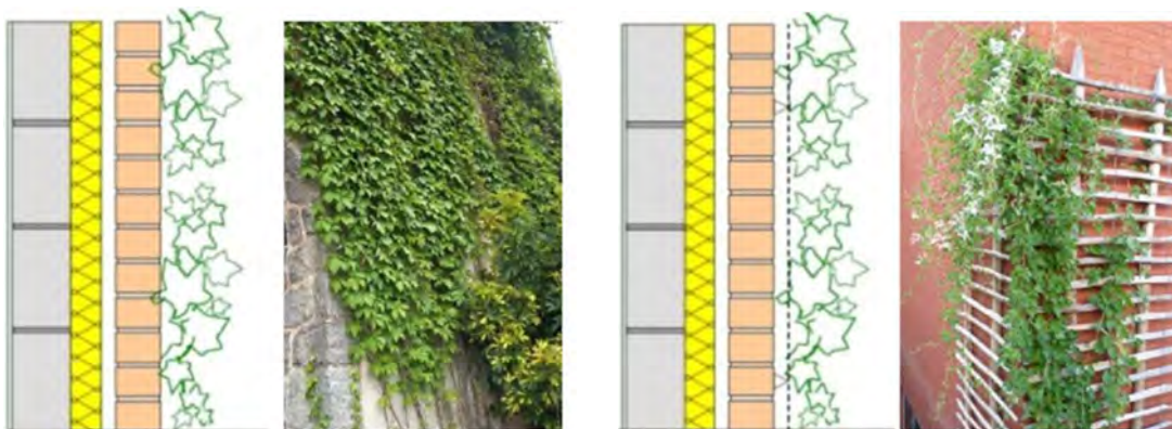
Figure 19 : direct Green Wall, dGF (à g.) – indirect Green Wall, idGF (à d.) [Kyra Koch & al.] – groenegevels.be
