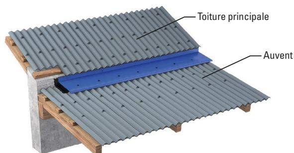
Figure 5 : Cas d'un auvent désolidarisé de la toiture principale
