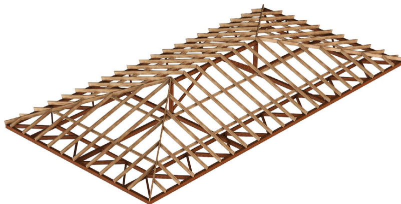
Figure 23 : Exemple de contreventement d'une charpente à 4 versants par poutres au vent horizontales dans le plan des entrails (certains éléments de la charpente ne sont pas représentés pour mieux visualiser les poutres au vent).
