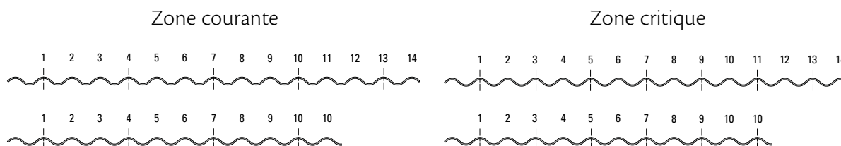
Figure 85 : Implantation des fixations sur une couverture en tôles ondulées de 14 et 11 ondes
