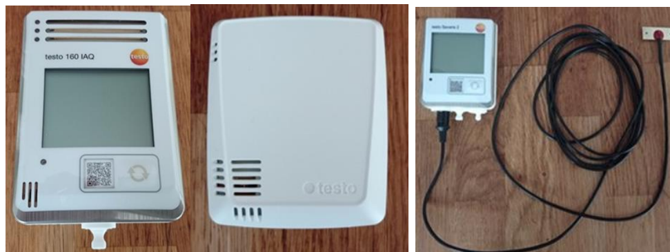
Photographie 1 : Modèles de capteurs déployés dans les logements (de gauche à droite) : 160IAQ – 160TH – Saveris
