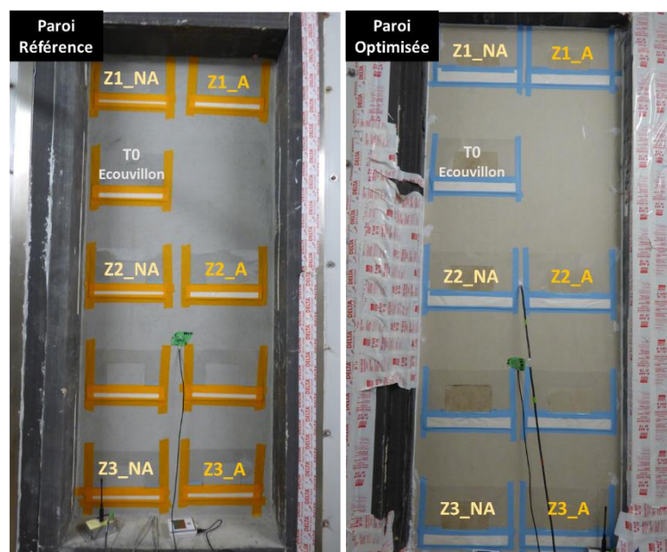
Photographie 12 : Identification des différentes zones d'inoculation sur la paroi « référence » (à gauche) et la paroi « optimisée » (à droite)
