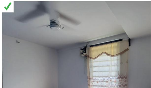
Dans cette chambre de 10 m<sup>2</sup> aux parois peu poreuses, la ventilation traversante est complétée par la position du brasseur d'air entre la porte et la fenêtre tout hauteur. Une vitesse d'air de 1 m/s permet d'abaisser la température ressentie de 4 °C. ©AQC
