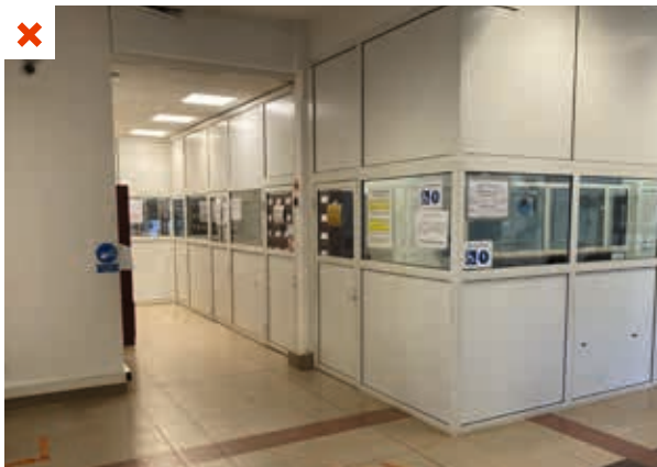
Série de bureaux cloisonnés n'ayant aucune ouverture vers l'extérieur et bénéficiant d'un accès limité à la lumière naturelle. ©AQC
