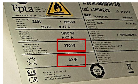
Photo 68 - Puissance du meuble : 370 W ; Puissance de l'éclairage : 82 W
