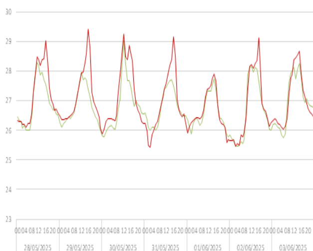
Evolution de la température sur un local orienté E/O (D22) ou N/S (D26)
