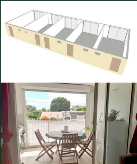
Les logements de cette copropriété sont très faiblement traversants ce qui limite significativement la ventilation naturelle. La porte d'entrée est une porte pleine permettant la sécurisation du logement. Les baies coulissantes en simple vitrage donnant sur les terrasses ne permettent pas de ventiler les logements de façon sécurisée, notamment la nuit ou en cas d'absence.
