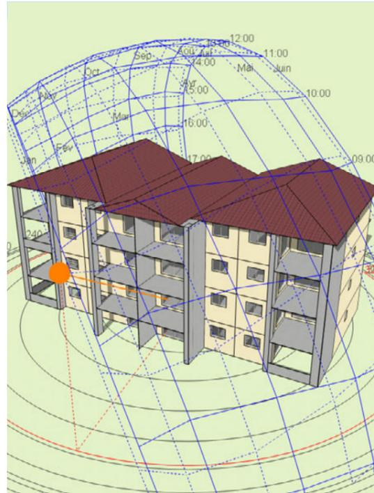
Dans le cadre du projet TropiCopro, l'ensemble des bâtiments audités a été modélisé par des simulations thermiques dynamiques via l'outil Designbuilder. Ces modélisations permettent d'analyser précisément le comportement thermique de ce type de bâtiment et de quantifier l'impact de différents types de travaux.
