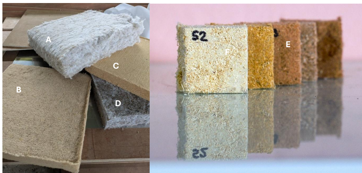
Figure 1 : photographies des panneaux isolants biosourcés testés dans l'étude. A à D : panneaux commerciaux ; A - BioFib, B - Pavaflex, C - Isolair, D - Emerwall. E et F : panneaux réalisés à partir de fibres de bois guyanais dans le cadre du projet ANR PANTHER 2 Guyane : E – Panneau de simarouba ( Simarouba amara ) ; F – Panneau de grignon ( Sextonia rubra )
