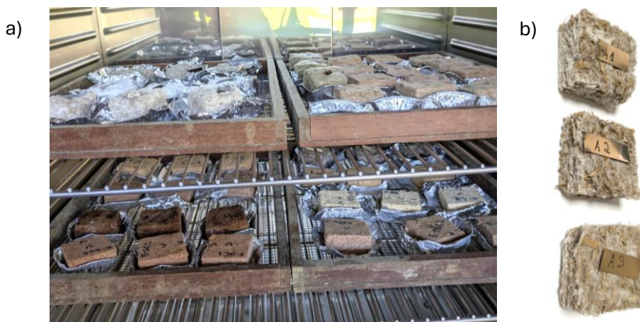
Figure 3 – a) Echantillons macroscopiques de matériaux isolants stabilisés en enceinte climatique (température et humidité relatives contrôlées) jusqu'à stabilisation ; b) Trois échantillons réplicas du panneau isolant à base de fibres de canne à sucre (Emerwall).
