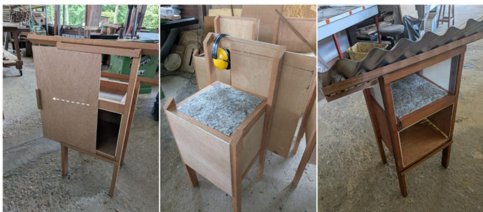
Figure 5 – Détail des étapes de fabrication d'un prototype de terrain (structure en grignon, parois en contreplaqué et toit en tôle ondulée). Dans cet exemple, le prototype est équipé du panneau Emerwall, pour une configuration combles fermés (plaques plexiglass).
