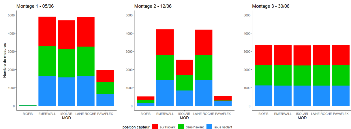
Figure 13 – Compte du nombre de mesures RH/T acquises par prototype, relevées pour les trois positions de capteurs (sur, dans et sous l'isolant) sur la durée d'un essai complet (4 jours).
