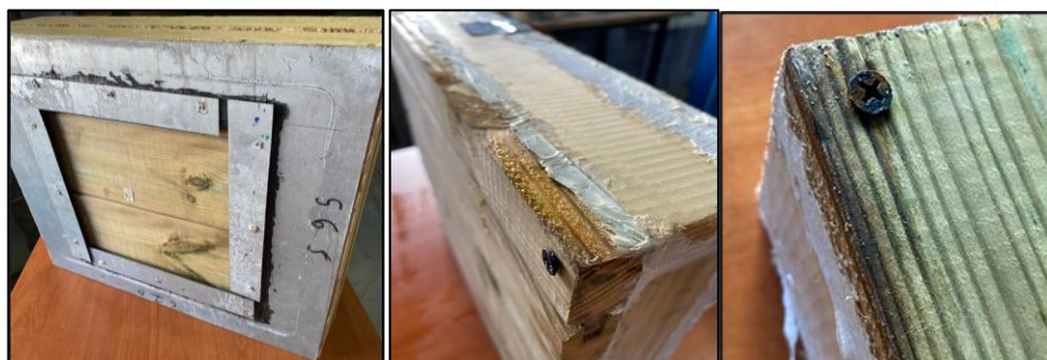
Figure 6 : Bâti expérimental, bardage et vis à la fin de l'essai
