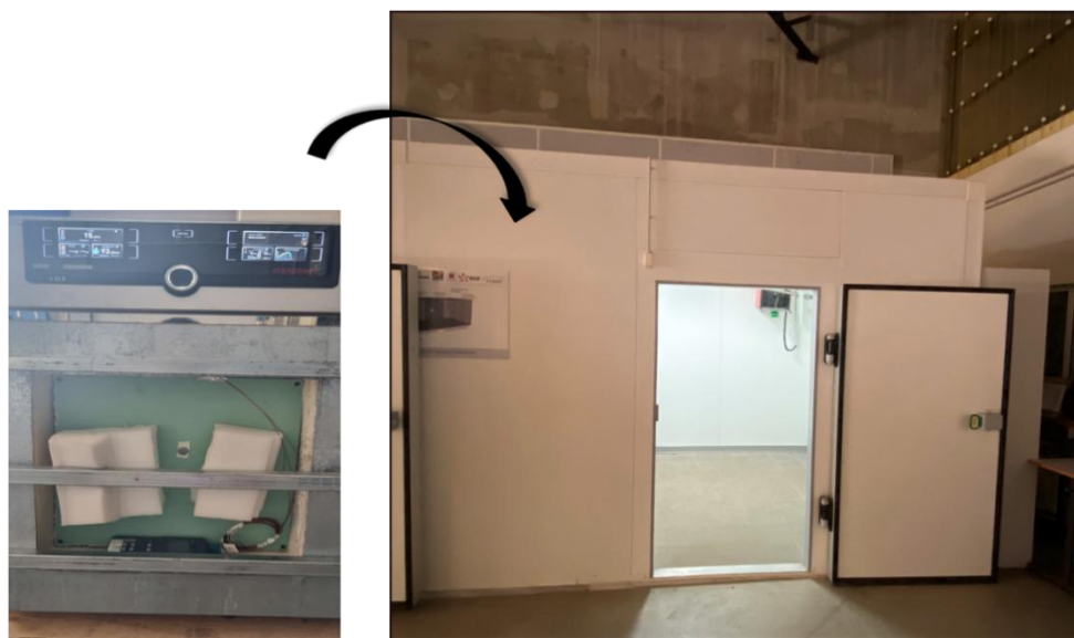
Figure 3 : Enceinte climatique à effet Peltier (à gauche) et enceinte climatique à échelle réelle (STATron)
