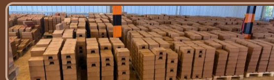
5 · Séchage des blocs
