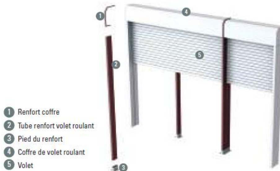
Figure 134 : Exemple de renforts sur volet roulant
